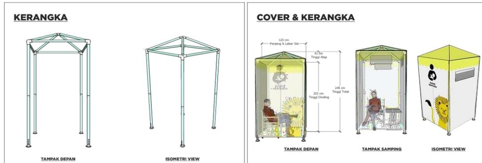
Gambar 9 Rancangan desain kerangka dan Rancangan Desain Cover dan Kerangka
