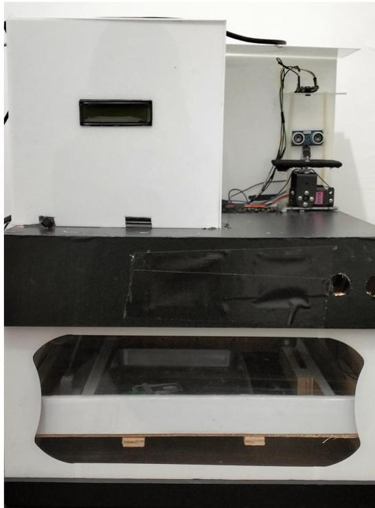
Gambar 5. Alat pemisah telur fertil dan infertile
