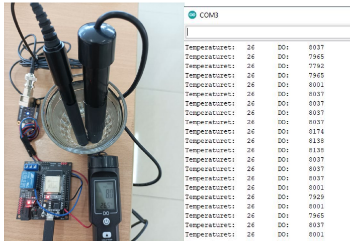
Gambar 11. Uji coba akurasi sensor DO
