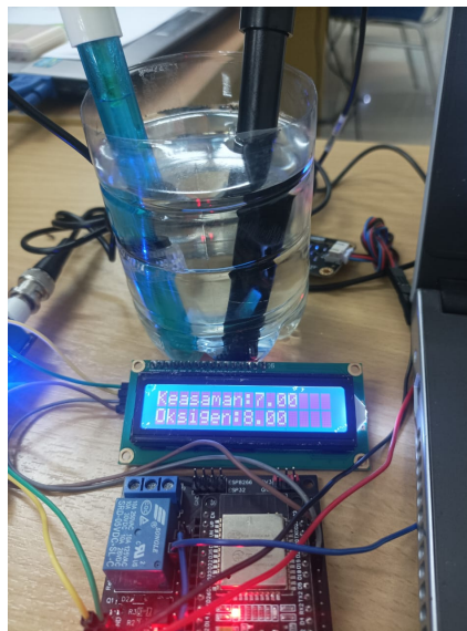
Gambar 10. Pengujian sensor Dissolved Oksigen
