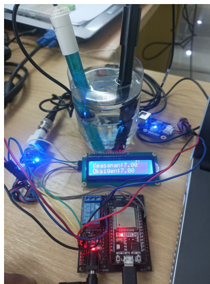
Gambar 7. Pengujian sensor keasaman (pH)
