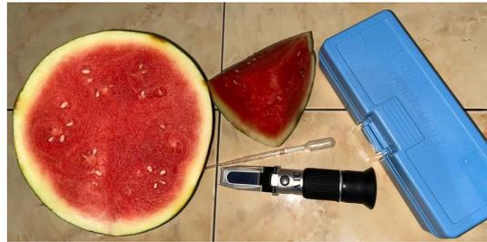
Gambar 3. Proses Pengambilan sampel Kadar Gula dalam Buah Semangka
