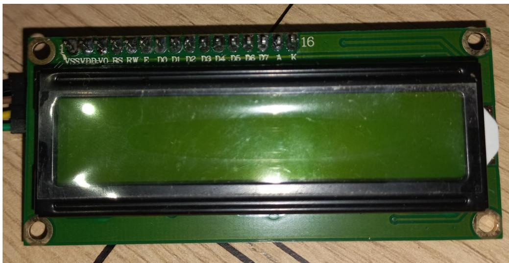
Gambar 3. LCD 16x2
