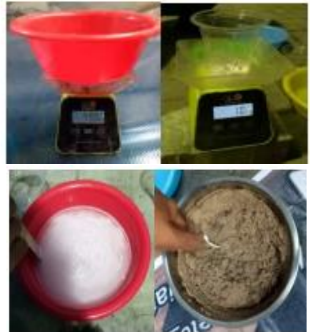
Gambar 5. Penimbangan dan pencampuran bagasse dengan dengan bahan tambahan
