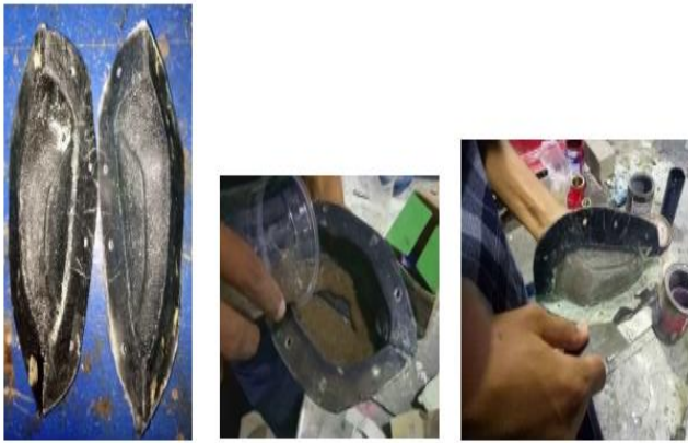
Gambar 7. Mold, pembuatan prototype dengan komposit dan pengeringan
