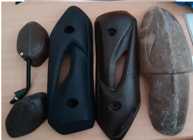
Gambar 8. Prototype spoon, cover knalpot, dan sparbor dari komposit
