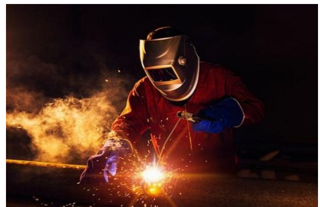
Gambar 1. Ilustrasi pengelasan menggunakan jenis las SMAW [6]
