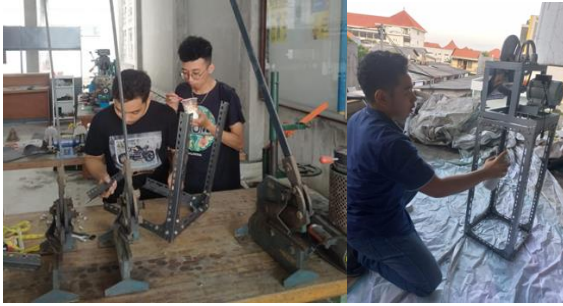
Gambar 4. Fabrikasi mesin pengiris pisang
