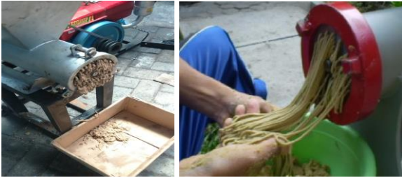
Gambar 7. Pencetakan pakan udang menggunakan mesin
